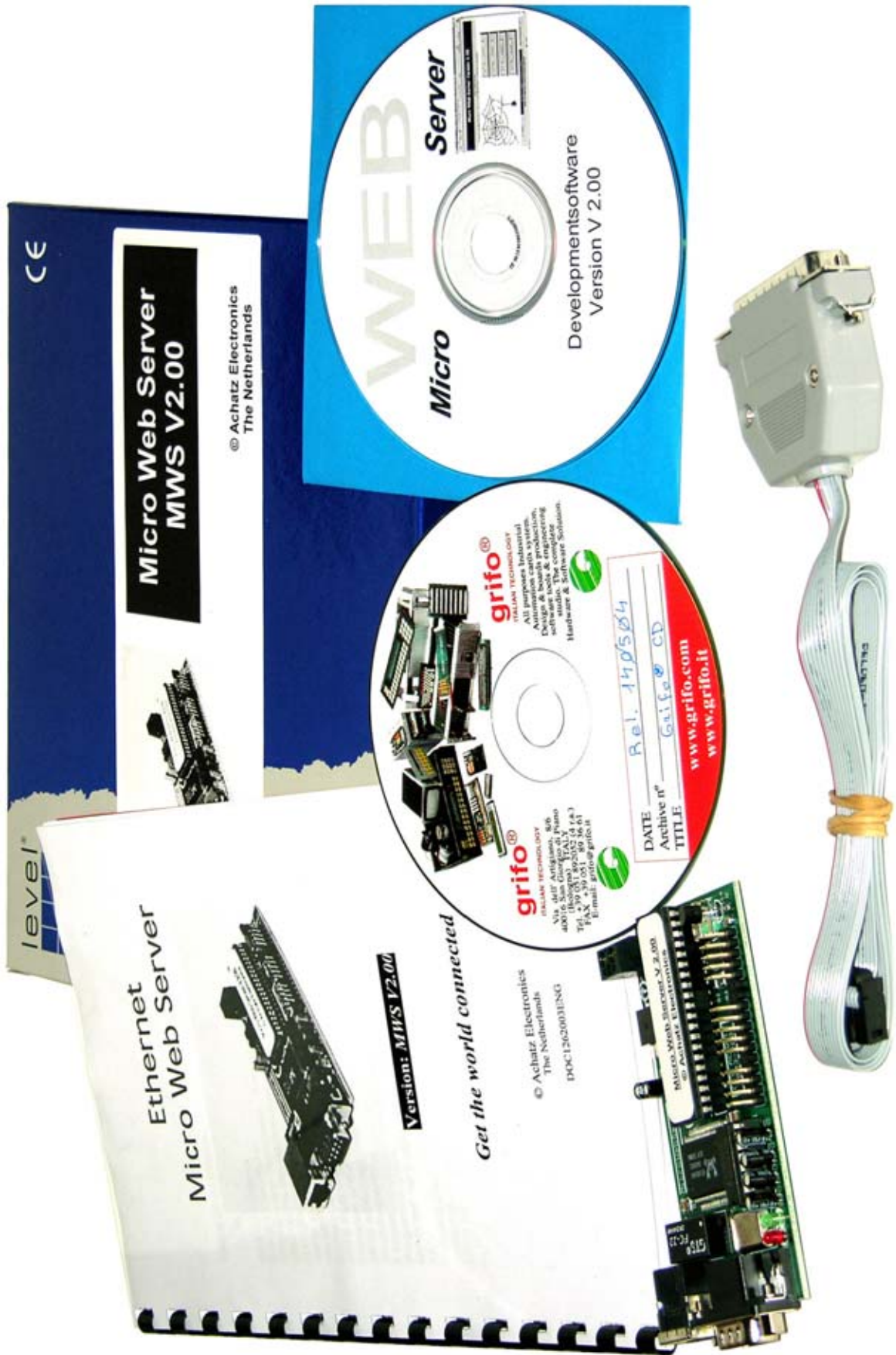
FIGURA 5: CONTENUTO DELLA CONFEZIONE DEL MODULO MICRO WEB SERVER
